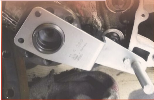
Kurbelwellen-Haltewerkzeug, zu verwenden wie BMW 11 4 320
